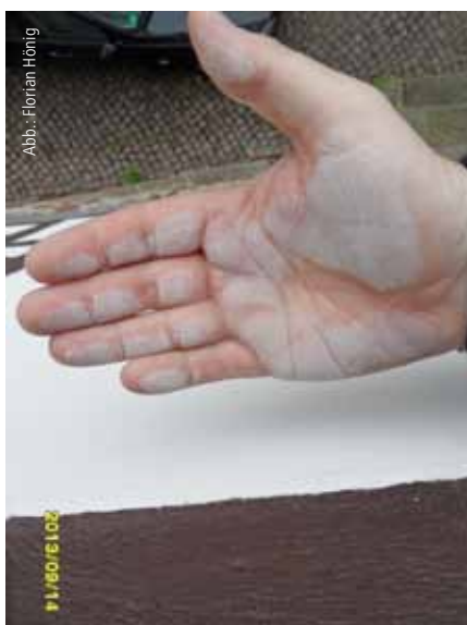
Abb. 4: Solch ein kreiender Altanstrich der Gefache kann nicht ohne weitere Vorbereitung überstrichen werden.
